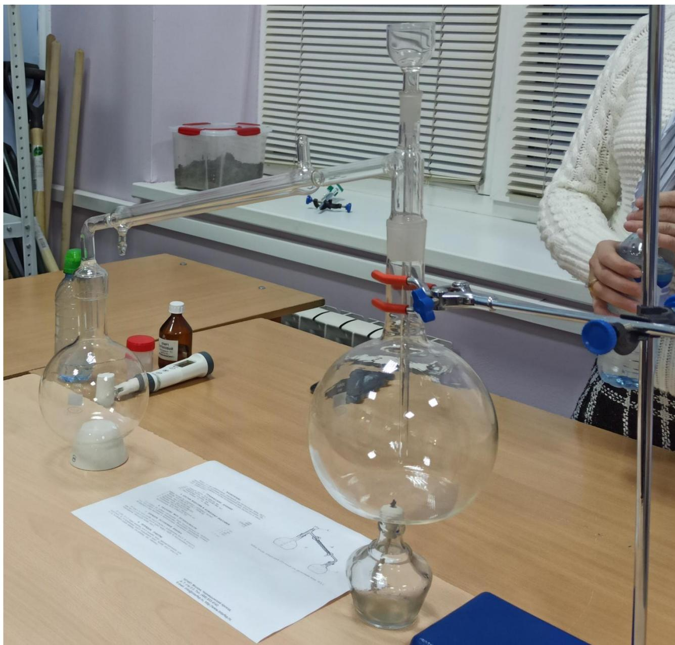
Далее мы налили воду и зажгли горелку, после чего началась конденсация воды на стенках колбы
